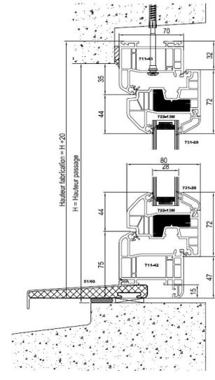
Dormant de 70 mm et pièce d'appui
